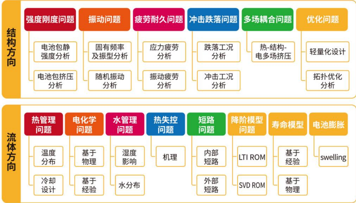
电池研发中主要的结构/流体问题
