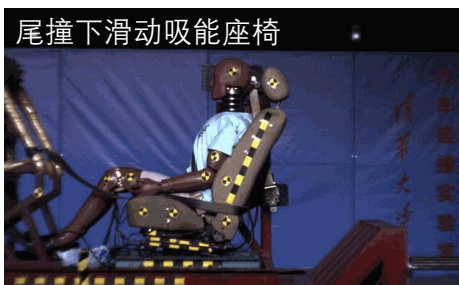
滑轨套滑轨及钢片拉弯吸能
